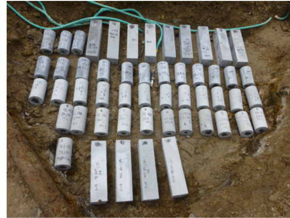
試験体の埋設状況
