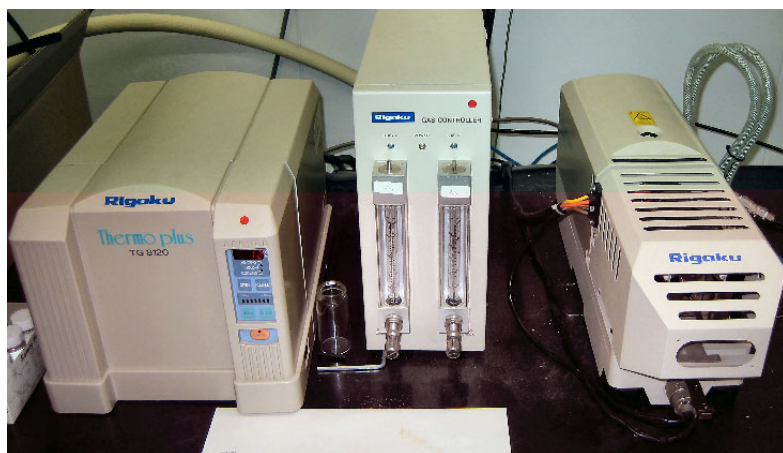
天秤ビーム式熱重量測定装置 (計測分析センター)
