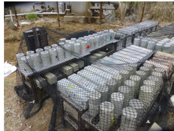
試験体の気中暴露状況
