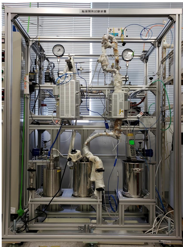
図3 本事業で開発したラボレベルのHiJET技術水素化装置
